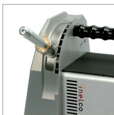
Slib elektroden i den ønskede vinkel.
