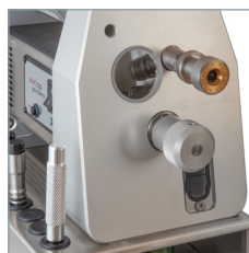
Drej håndtaget for at afkorte elektroden
